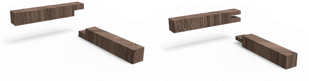
ภาพที่ 4.17 แสดงการเชื่อมต่อของเส้น แบบการบากตัว L และ ตัว U ประกอบกับตัว T
