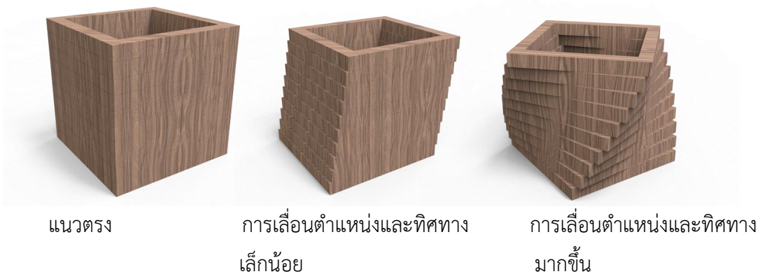
ภาพที่ 4.27 แสดงการซ้อนกันของชั้นโครงสร้างกรอบ
