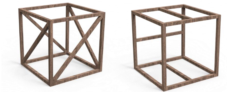
ภาพที่ 4.22 แสดงการเพิ่มส่วนเสริมโครงสร้างระหว่างกรอบบน และล่าง
