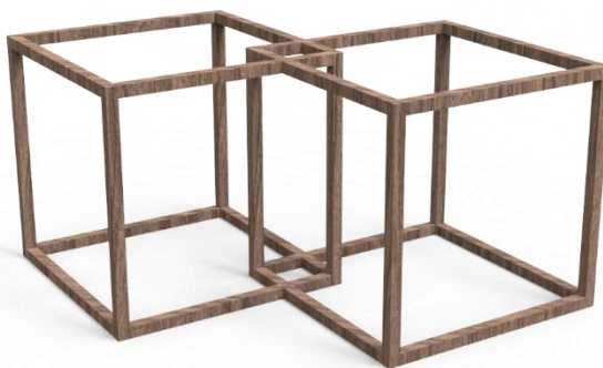
ภาพที่ 4.25 แสดงการเพิ่มส่วนของรูปทรงกรอบบน และล่าง ให้อยู่เป็นเส้น หรือ เป็นกรอบเสริม
