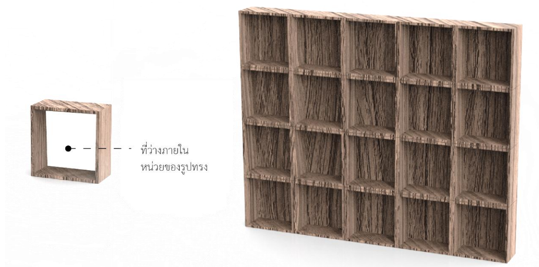
ภาพที่ 5.16 แสดงหน่วยของรูปทรงและการประกอบโครงสร้างผนัง
