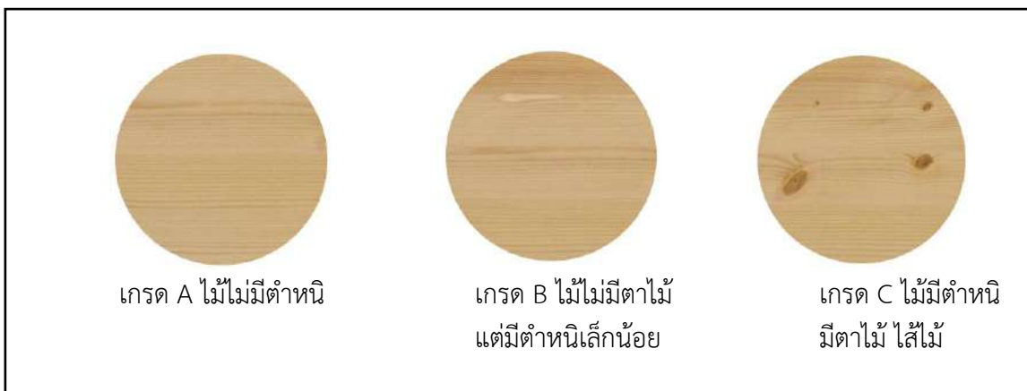
รูปที่ 3.6 ลักษณะไม้ประสานยางพารา แบ่งตามเกรด
